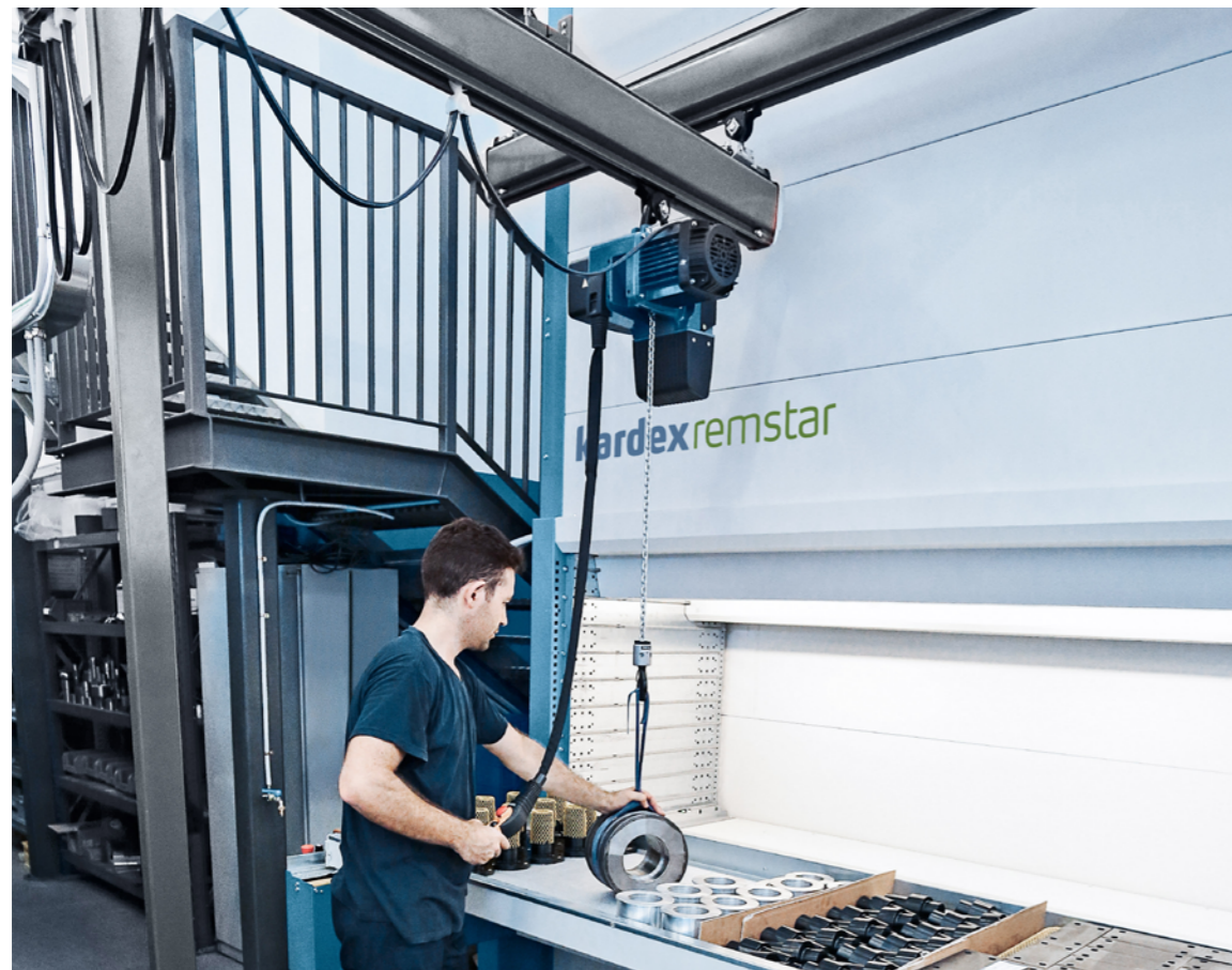
垂直升降式仓储系统Kardex Shuttle集成了升降起重装置
